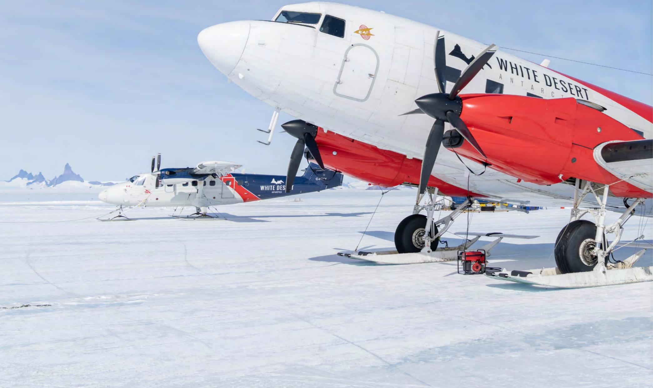
Наши самолёты Basler BT-67 — это модернизированная версия самолёта DC-3, оснащённая новейшей авионикой для полетов внутри Антарктики и специально разработанными лыжами для посадки на снег и лёд.
