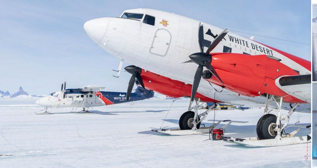
Unsere Basler BT-67-Flugzeuge sind aufgerüstete Umbauten der DC-3 und speziell für den Antarktisbetrieb mit modernster Bordelektronik und speziell für die Landung auf Schnee und Eis konzipierten Skis ausgestattet.
